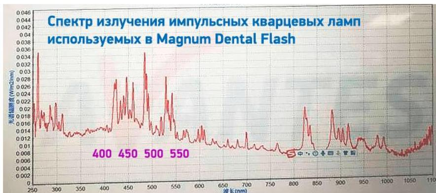
*Широкий диапазон длин волн – от 280 до 700 нм и высокая интенсивность обеспечивают высокое качество полимеризации.*
